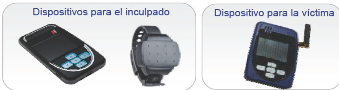
El inculpado porta un transmisor (brazalete o tobillera) que se ajusta a su cuerpo mediante una correa y que está emparejado a través de repetidas señales de radiofrecuencia con un dispositivo de rastreo GPS.
